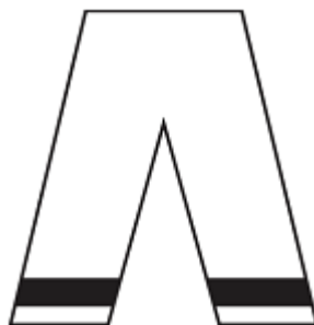
Hình 2 - Mẫu tối thiểu để bố trí vật liệu có độ nhìn rõ cao trên quần áo che phủ phần thân dưới gồm cả chân (mặt trước và mặt sau)
